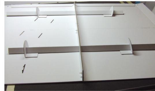
3 Former les raidisseurs en triangle et insérer les dans les guides horizontaux.
