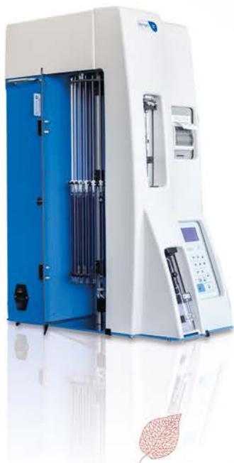
Mesure automatisée de la vitesse de sédimentation dans le respect de la méthode de Westergren
