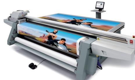
Impression U.V. quadrichromie Haute-Définition 1440 DPI + Blanc de soutien partiel ou total, machine à plat et/ou en continu, format 250 x 125 cm, épaisseur du support jusqu'à 48 mm
